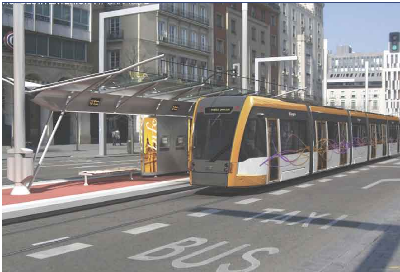
A su paso por el Casco Histórico de Zaragoza, el tranvía no empleará catenarias hasta la plaza Aragón.
